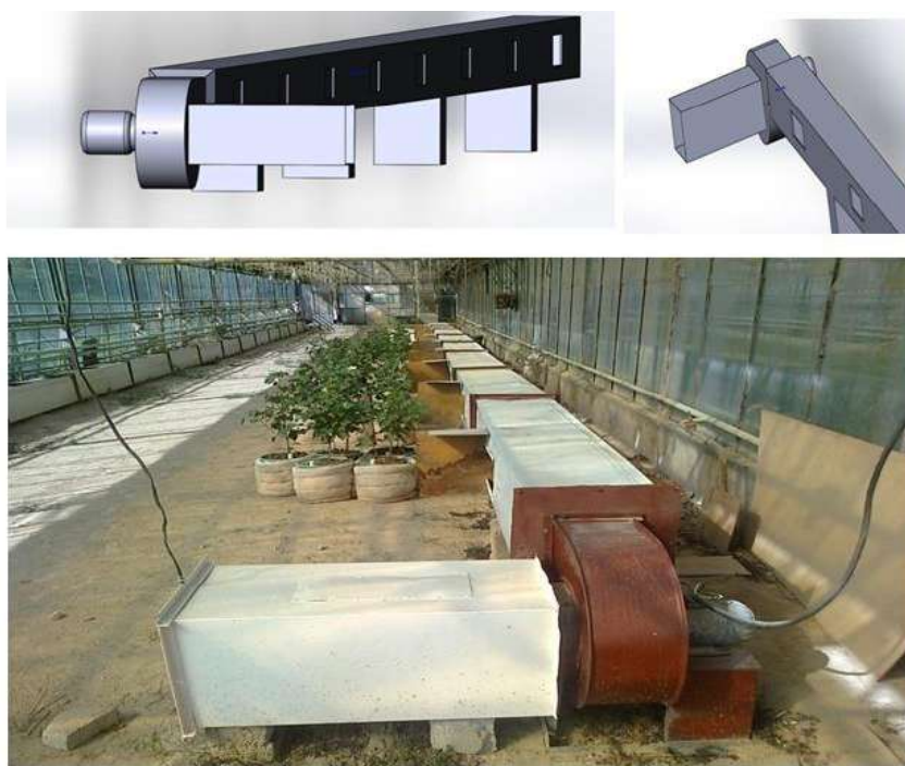
Рис.8. Приспособление для искусственного гармсиля и вид опыта.
