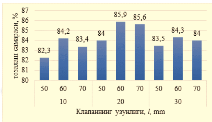
4.2-расм. Клапаннинг конуслик бурчагини, узунлигини ўзгаришидан пахтани тозалаш самарасига боғлиқлиги.
