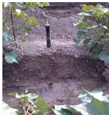
1-2 расмлар. WFD асбобининг далага ўрнатилганда ер остидаги (чапда) ва ер устидаги (ўнгда) кўриниши.
