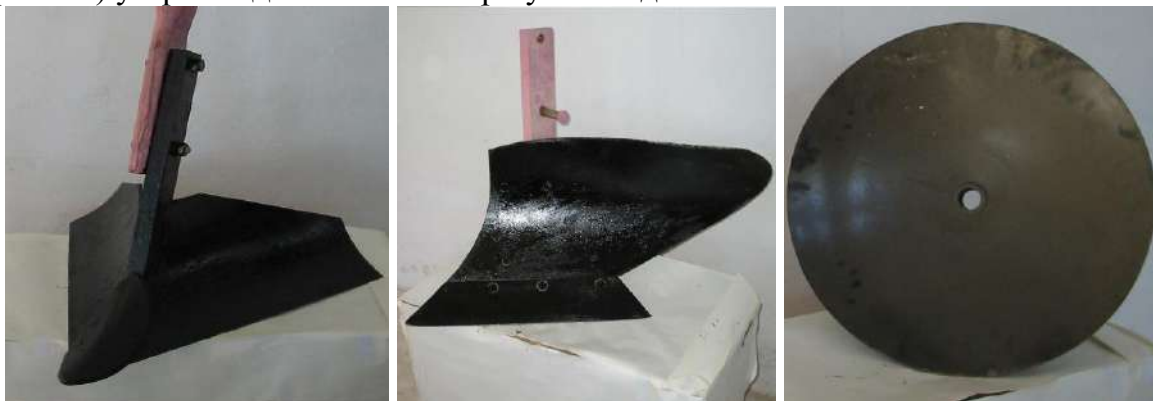
а) ГХ-4 пушта олгичининг иш органи; б) ПД-4-45 икки ярусли плугнинг юқори корпуси; в) ТДБ-3/5 диски боронанинг сферик диски
