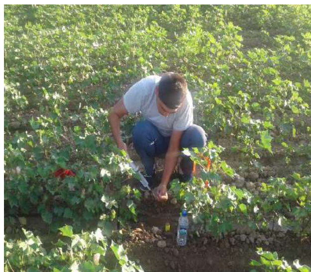
5-6-расмлар. WFDнинг детектори ёнгач, филтрдан ўтиб тўпланган сув намунасининг таҳлил учун олиниши (қ.х.ф.ф.д. Н.Дурдиев, таянч докторант Ф.Ғоппоров).
