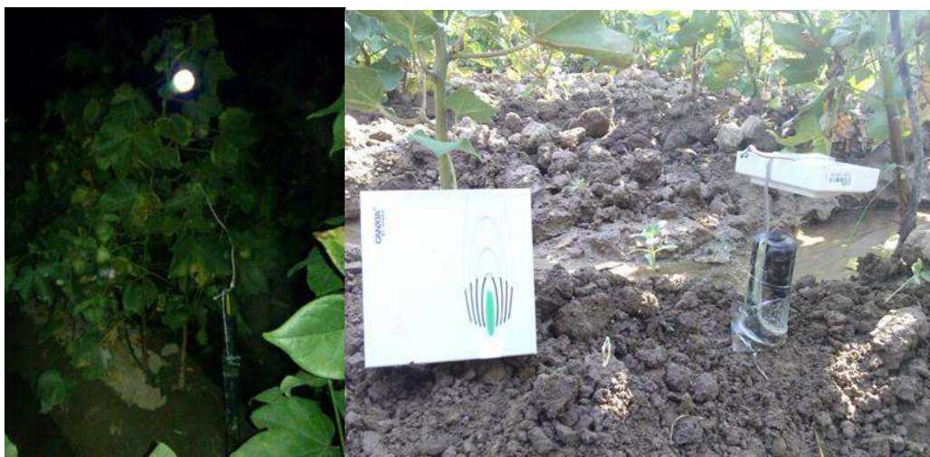
7-8 расмлар. Сув керакли қатламга етиб борганда фонарнинг ёниши ва сигналнинг ишлаши.
